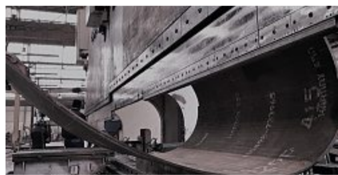
Profilo in Hardox450 in lavorazione su piegatrice da 3000 ton.
